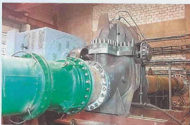
Рис. 5. Испытания головного образца насоса Desum D 700-1000В (Q = 8000 м³/ч; H = 116 м)
