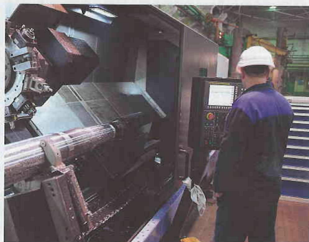
Рис. 7. Обработка вала насоса 700-1000В в обрабатывающем центре Doosan PUMA 5000
