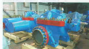
Рисунок 2. Насос НГПН-М 1250-160. Проекты: «Заполярье-Пурпе» (ОАО «АК «Транснефть»), НПС «Уренгойская» и ПСП «Заполярный» (ОАО «Газпром»).
